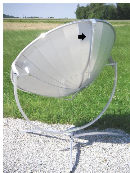
Rückansicht des Solarkochers. Der Reflektor ist durch einen Überrollbügel (siehe Pfeil) vor Beschädigungen geschützt.
